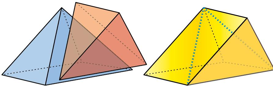
En marquant en bleu pointillé les diagonales des deux losanges (qui étaient deux arêtes du tétraèdre) on voit bien comment deux faces triangulaires se retrouvent dans un même plan pour former une face losange.
